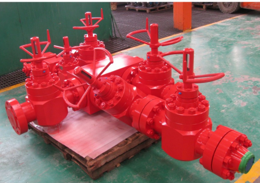
◀ 泥浆线路管汇
